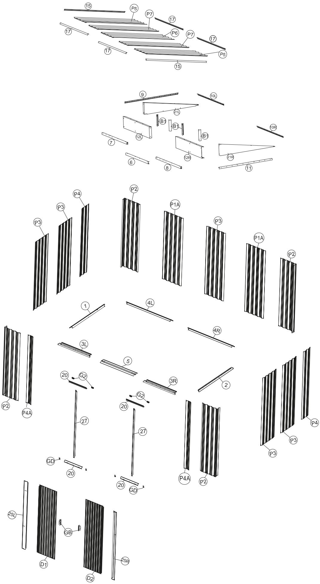
1. Kiinnitä kehikon pohjalistat (osat 1–4L) toisiinsa ruuveilla (F1). Kohdista ja aseta kynnislista (5) pohjalistojen (3L ja 3R) väliin. Kiinnitä kynnislista paikalleen ruuveilla (F1). Varmista, että listat muodostavat täydellisen suorakulmion.
