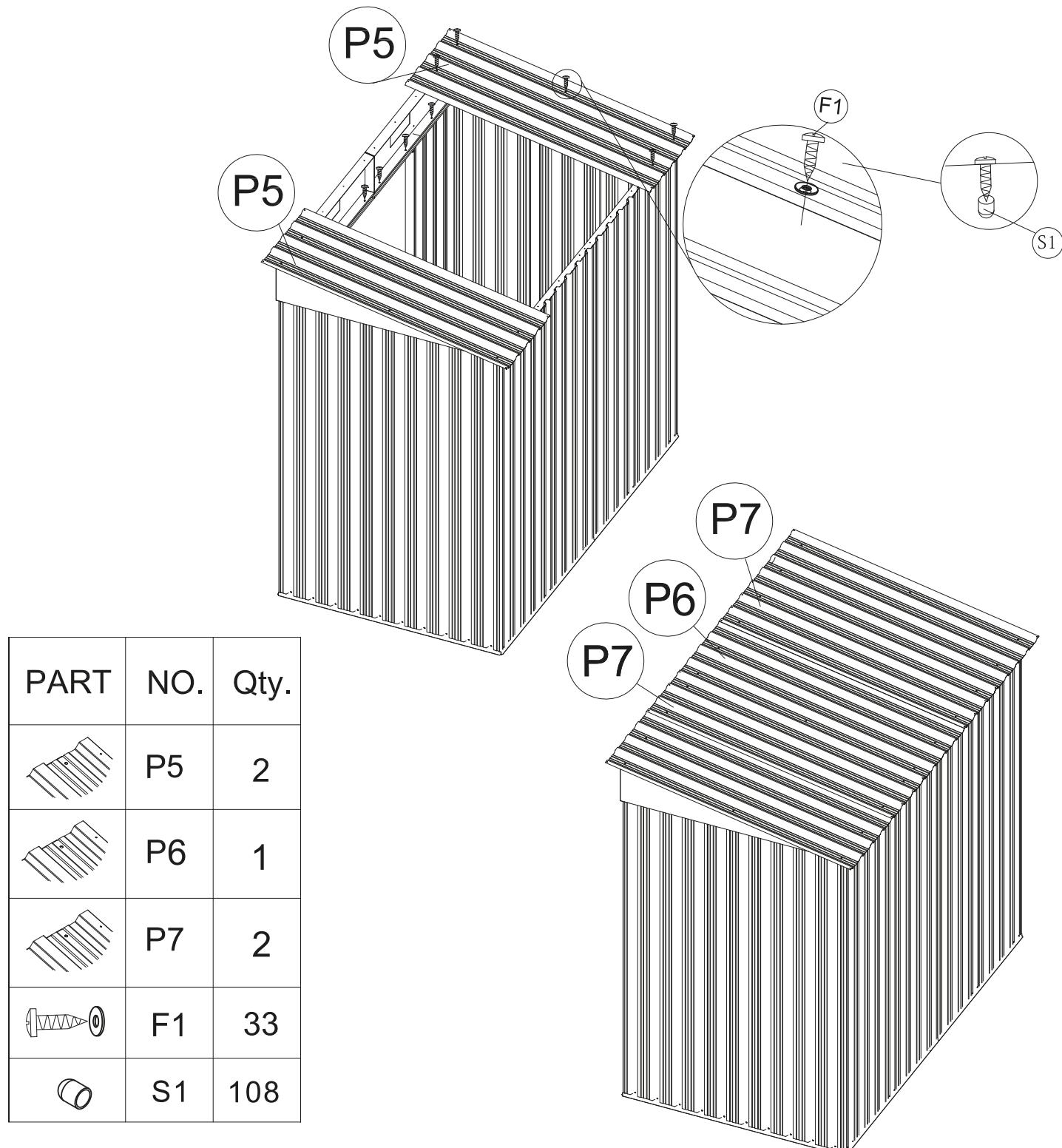
8. Asenna katon suojapellit (15 ja 17) kattopaneeleihin. Kiinnitä suojapellit paikoilleen ruuveilla ja aluslevyllä (F1). Aseta sitten neljä kulmakappaletta (GC) suojaapelten liitoskohtiin ja kiinnitä ne paikoilleen ruuveilla ja aluslevyllä (F1).
