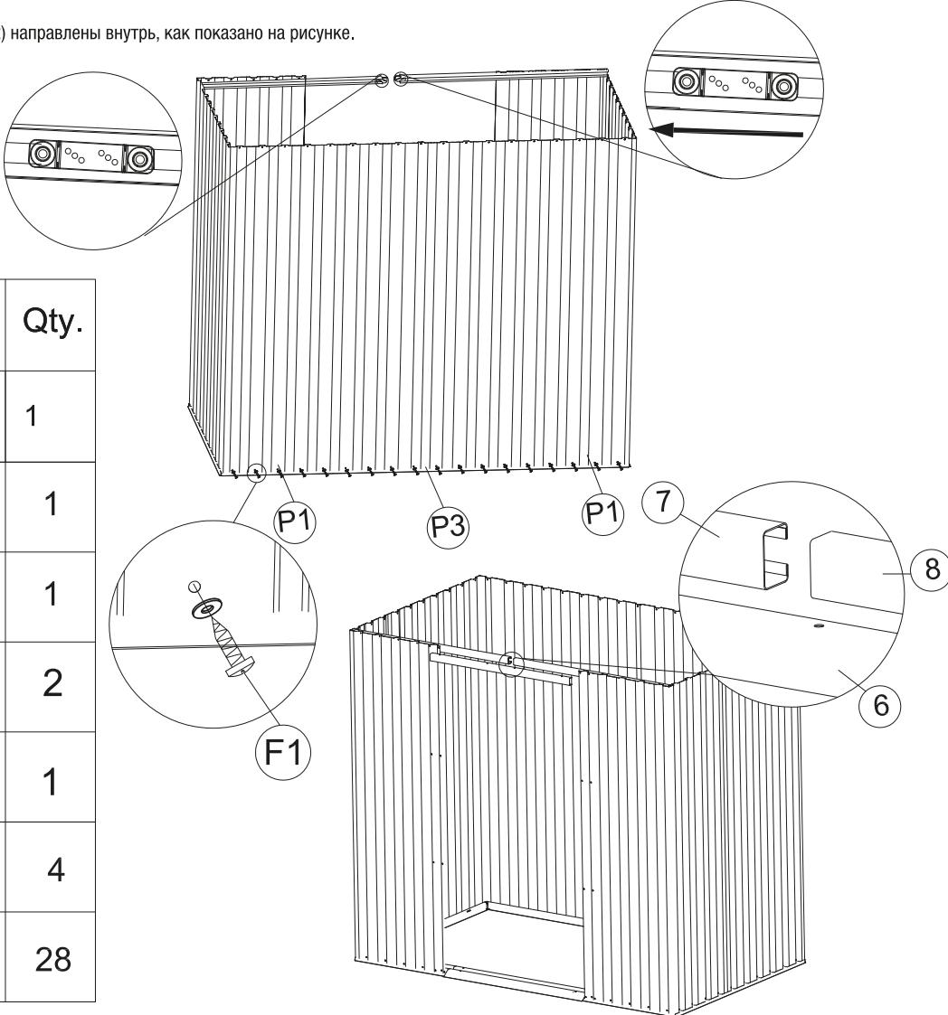
4. Aseta kulmalistat (9, 10L, 10R ja 11) seinäpaneeliin kuvan osoittamalla tavalla. Kohdista kulmalistojen reiät seinäpaneelien reikien kanssa ja kiinnitä kulmalistat paikoilleen ruuveilla ja aluslevyllä (F1). Aseta sitten seinäpaneelit (P1, P2 ja P3) pohjalistojen ja kulmalistojen väliin. Kiinnitä ne paikoilleen ruuveilla ja aluslevyllä (F1). Huomaa: varmista, että kulmalistat asettuvat limitän alla olevan kuvan mukaisesti.
