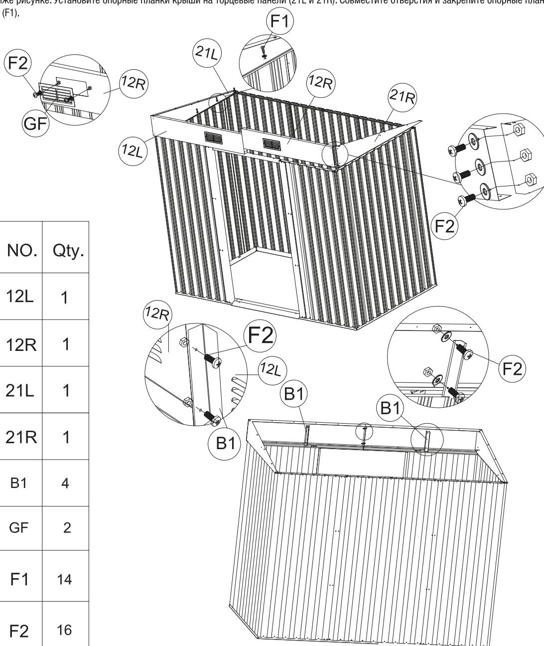
7. Kiinnitä kattopaneelit (P5, P6 ja P7) päätypaneeliin (ja katon tukilistoihin). Kohdista reiät toisiinsa ja kiinnitä kattopaneelit paikoilleen ruuveilla ja aluslevyllä (F1). Kiinnitä jokaisen ruuvin päähän tulppa (S1). Huomaa: varmista, että kattopaneelit asettuvat limittään paikoilleen.
